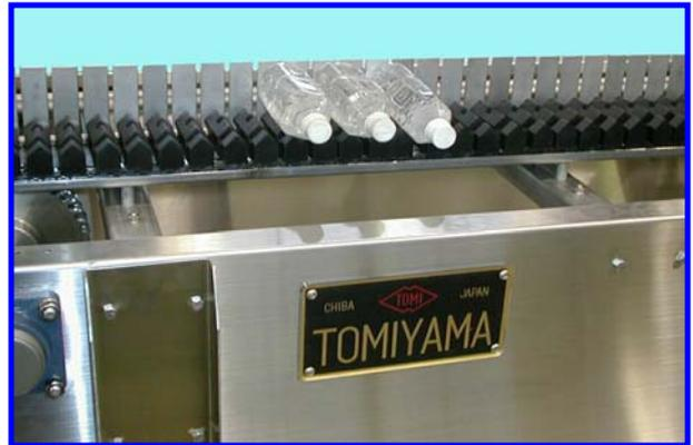
100度転倒を行い、容器内部のすみずみまで、高温充填液で殺菌します。
